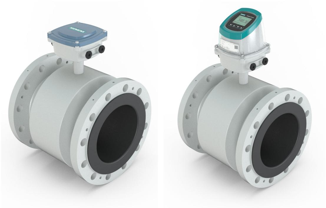
Sensorgehäuse und Flansche sind aus Edelstahl (AISI 304) oder Kohlenstoffstahl (ASTM A 105) und der Anschlusskasten aus Polycarbonat. Das Messrohr besteht aus Edelstahl (AISI 304) und die Auskleidungen und Elektroden sind in einer Vielzahl verschiedener Werkstoffe verfügbar, wodurch der Sensor hochbeständig gegen eine große Bandbreite von Chemikalien ist.
