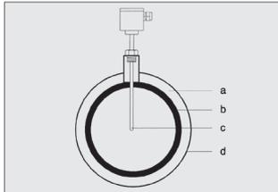
Typische Anordnung zur Reduzierung der Temperaturableitung
