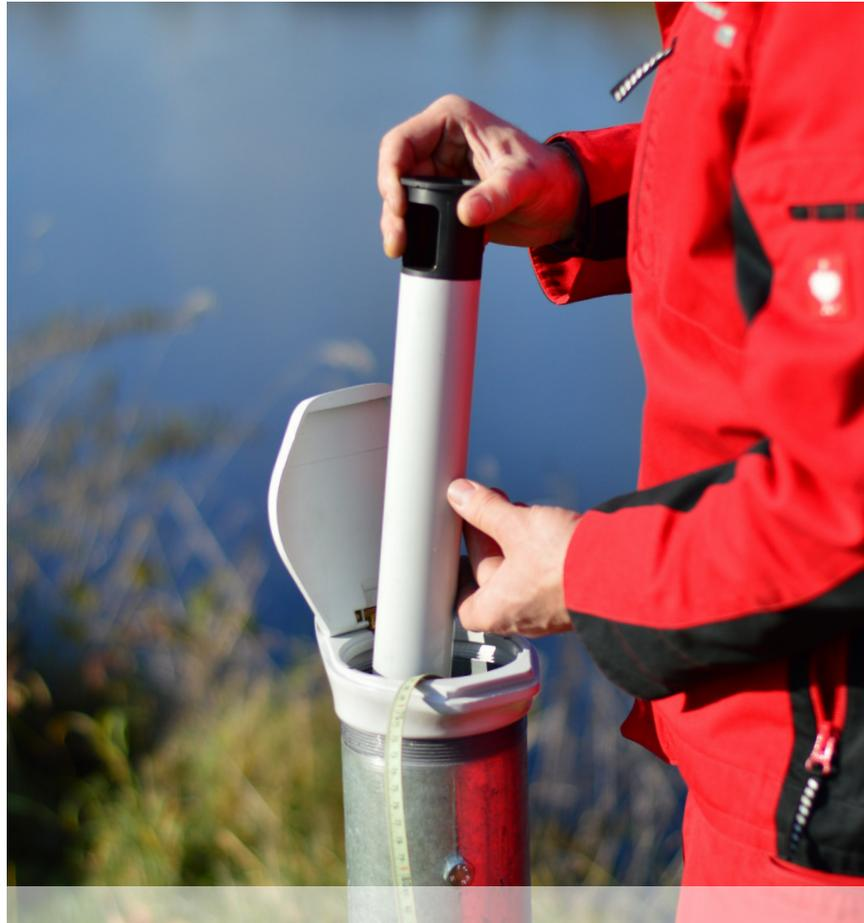
Pegelmessung mit Datenlogger für Rohreinbau
