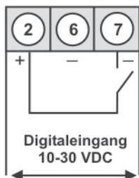
DAM-311x0x00S mit Digitaleingang und externer Spannungsquelle
