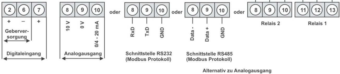
DAM-311x0x00S mit Digitaleingang in Verbindung mit 24 VDC Geberversorgung
