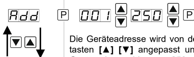
Die Geräteadresse wird von der kleinsten zur größten Stelle mit den Richtungstasten [▲] [▼] angepasst und stellenselektiv mit [P] bestätigt. Es steht eine Geräteadresse bis max. 250 zur Verfügung. Schnittstellendaten: Baudrate 9600 bit/s, 8 Databite, 1 Stopbit, keine Parität (8n1).
