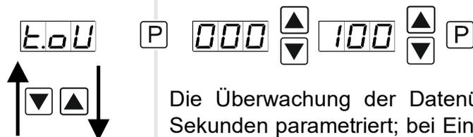
Die Überwachung der Datenübertragung wird in Sekunden bis maximal 100 Sekunden parametrierbar; bei Eingabe von *000* findet keine Überwachung statt. Das Timeout wird von der kleinsten bis zur größten Stelle mit [▲] [▼] angepasst und stellenselektiv mit [P] bestätigt. Nach der letzten Stelle wechselt die Anzeige in die Menü-Ebene.
