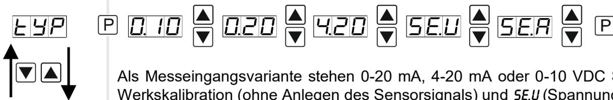
Als Messeingangsvariante stehen 0-20 mA, 4-20 mA oder 0-10 VDC Signale als Werkskalibration (ohne Anlegen des Sensorsignals) und *SE.U* (Spannung) oder *SE.A* (Strom) als Sensorkalibration (mit angelegtem Messsignal) zur Verfügung. Mit **[P]** wird die Auswahl bestätigt und die Anzeige wechselt zurück zur Menü-Ebene.
