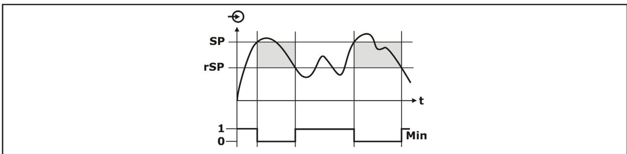
Der Schaltausgang wird aktiviert, wenn der aktuelle Messwert den Rückschaltpunkt unterschreitet und die eingestellte Rückschaltverzögerungszeit abgelaufen ist.
