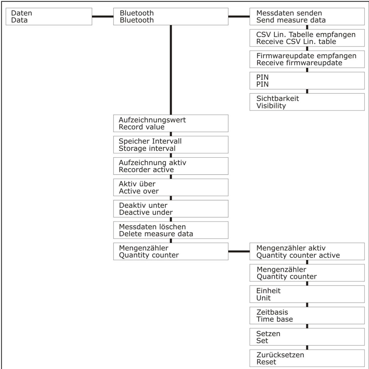
Das Gerät ist in der Lage, etwa eine halbe Million Messwerte verlustsicher aufzuzeichnen. Die Aufzeichnung erfolgt im Ringspeicherverfahren, wobei nach einer Vollspeicherung als nächstes die ältesten Messwerte überschrieben werden. Die gespeicherten Messwerte können entweder graphisch in der Anzeigeart Chart dargestellt oder per Bluetooth-Interface als CSV-Datei exportiert werden. Über das Bluetooth-Interface ist der Download von Linearisierungs- oder Firmwaredateien möglich.
