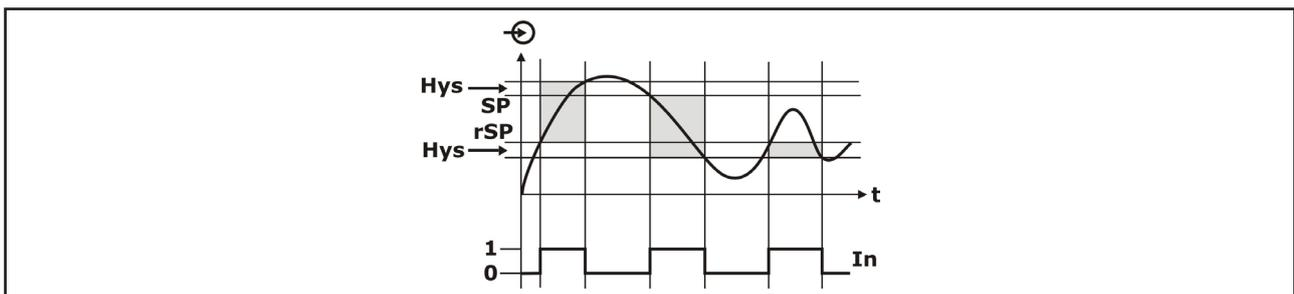
Der Schaltausgang wird aktiviert, wenn der aktuelle Messwert innerhalb des durch Schaltpunkt und Rückschaltpunkt definierten Bereiches liegt und die eingestellte Einschaltverzögerungszeit abgelaufen ist.
