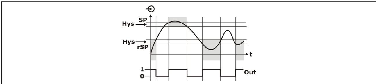
Der Schaltausgang wird aktiviert, wenn der aktuelle Messwert außerhalb des durch Schaltpunkt und Rückschaltpunkt definierten Bereiches liegt und die eingestellte Einschaltverzögerungszeit abgelaufen ist. Der Schaltausgang wird deaktiviert, wenn der aktuelle Messwert innerhalb des durch Schaltpunkt und Rückschaltpunkt definierten Bereiches liegt und die eingestellte Rückschaltverzögerungszeit abgelaufen ist.
