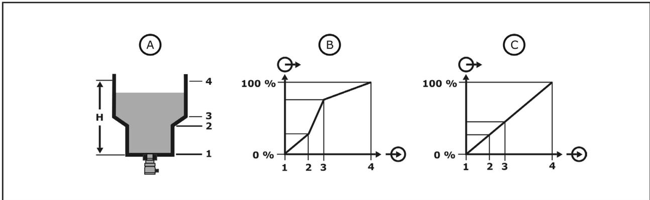
Durch die integrierte Linearisierungsfunktion ist es möglich, eine Linearisierung des Messsignals, z.B. zur Volumenberechnung bei konischen oder liegenden zylindrischen Behältern oder auch zur Durchflussberechnung durchzuführen.
