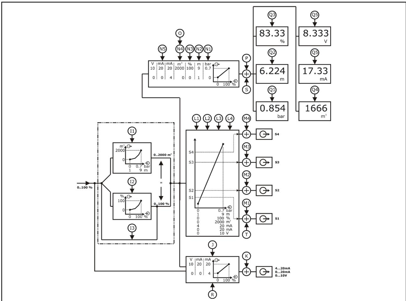
I1 - Linearisierung > Grundeinheit - Display Skalierung z.B. 0..0,7 bar / 1..9 m = 0..2000 m<sup>3</sup>
