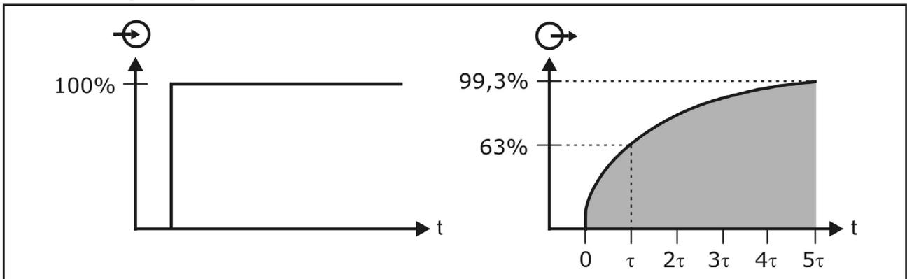
Die Dämpfung beeinflusst die Geschwindigkeit, mit der Anzeige, Ausgangssignal und Schaltausgänge auf Änderungen des Messsignals reagieren.
