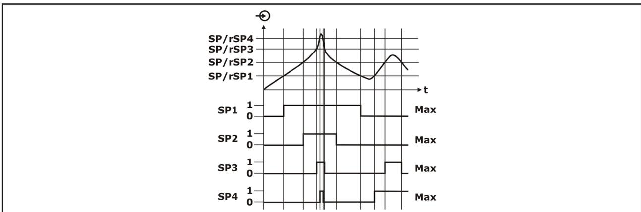
Schalt- und Rückschaltpunkt können auf verschiedene Werte eingestellt werden, um komplexe Schaltmechanismen zu erhalten.
