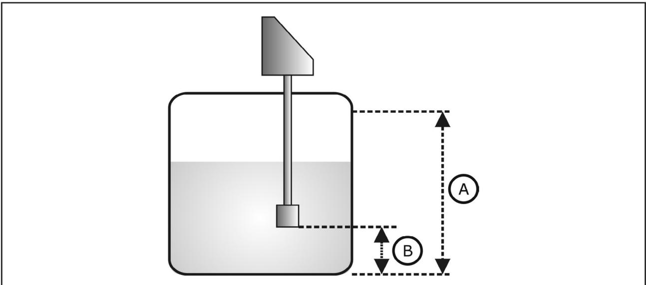
A - Maximaler Füllstand
