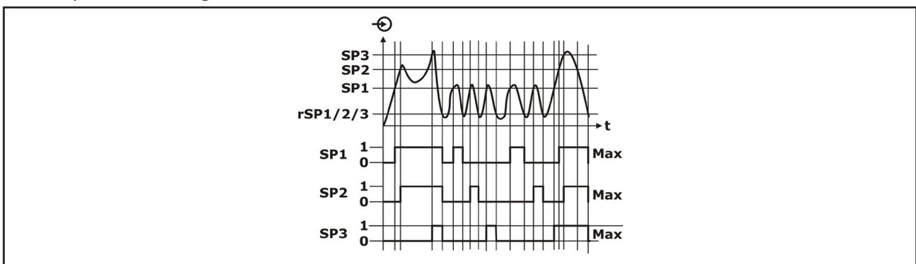
Der Index des zuletzt eingeschalteten Schaltausganges wird nicht gespeichert, d. h. nach dem Einschalten wird immer mit dem Schaltausgang mit dem kleinsten Index gestartet.
