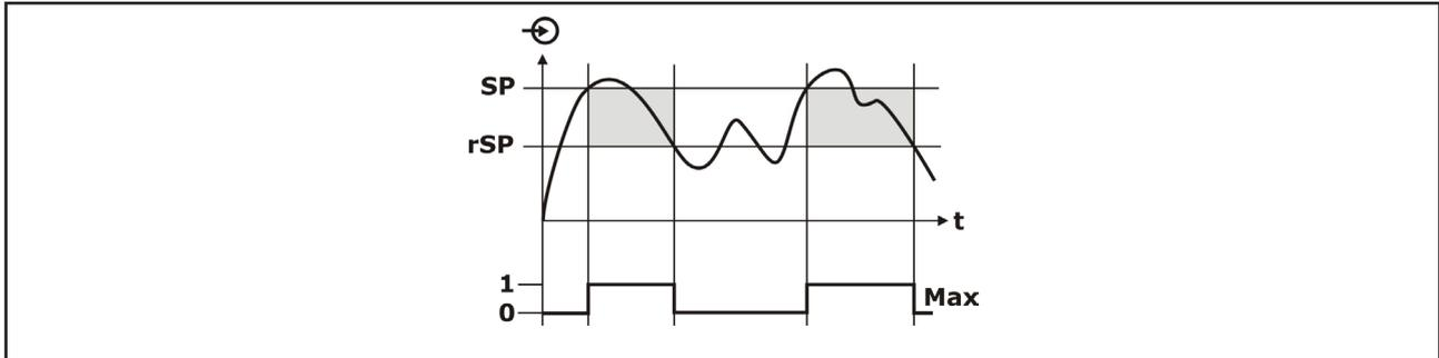
Der Schaltausgang wird aktiviert, wenn der aktuelle Messwert den Schaltpunkt überschreitet und die eingestellte Einschaltverzögerungszeit abgelaufen ist.
